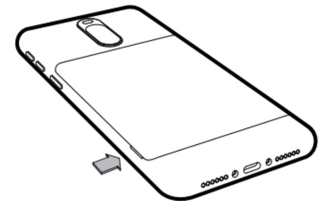
zu können, musst du zuerst den Akku herausnehmen (Abb. 2). Die Slots für zwei nanoSIM-Karten und eine microSD-Karte befinden sich oberhalb des Akku-Einschubs (Abb. 3). Die SIM-Karten rasten spürbar ein. Deine modulare eSIM-Karte (falls gewünscht und vorhanden) kannst du in einem der beiden
