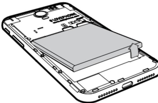
tragbaren Speicher. Anschließend kannst du den Akku wieder einlegen und das Gerät verschließen. Durch langes Drücken der Powertaste lässt sich dein SHIFT5me nun starten. Eine ausführliche Anleitung dieser und der darauffolgenden Schritte findest du hier: [shiftphones.com/5me-firststeps](https://shiftphones.com/5me-firststeps)
